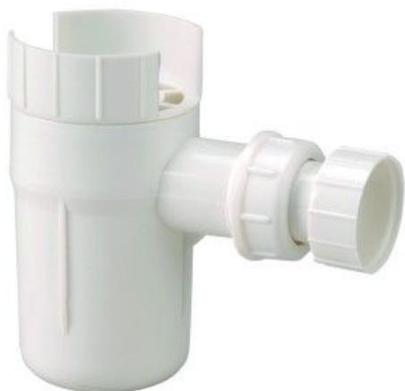
L'entonnoir siphon est à connecter entre le groupe de sécurité et le tout-à-l'égout pour récupérer l'eau qui s'écoule du groupe de sécurité lors de la montée en pression du chauffe-eau.
