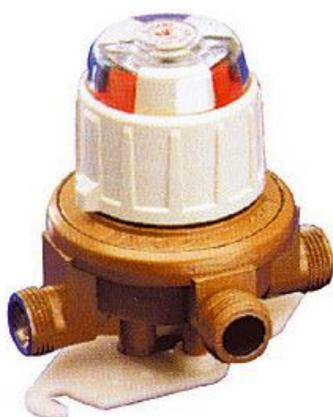
Cet inverseur automatique assure la continuité de l'alimentation en gaz en basculant automatiquement sur une deuxième bouteille lorsque la première est vide.
