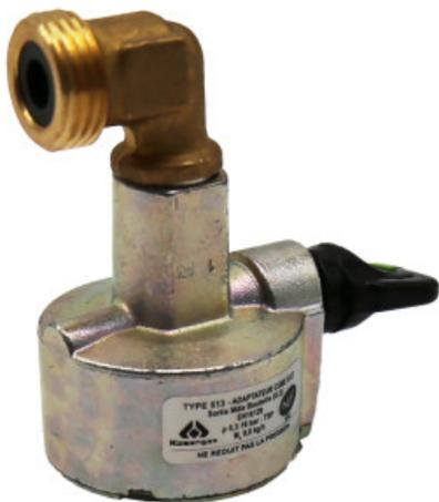
Cet adaptateur permet de raccorder rapidement les petites bouteilles de 6 kg de butane ou propane équipées de valves automatiques, spécifiquement pour les bouteilles Le CUBE BUTAGAZ et VISEO avec une valve de 27 mm de diamètre.
